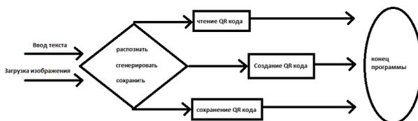
Рис. 1. Блок-схема работы программы по генерации QR-кодов
